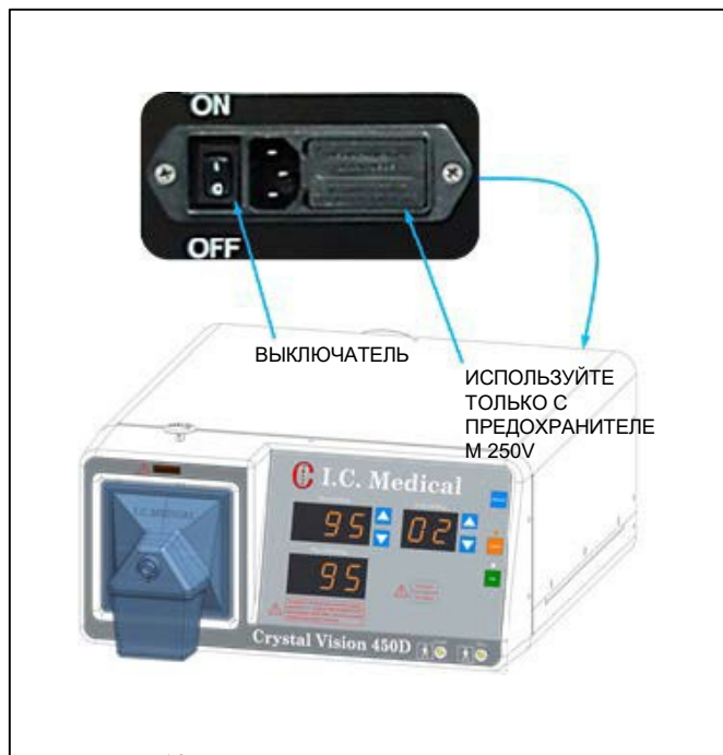
Рисунок 12: Расположение переключателя питания.
