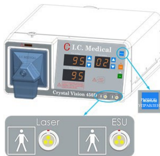
Рисунок 13: Кнопка ручного управления и разъемы для сенсоров.
